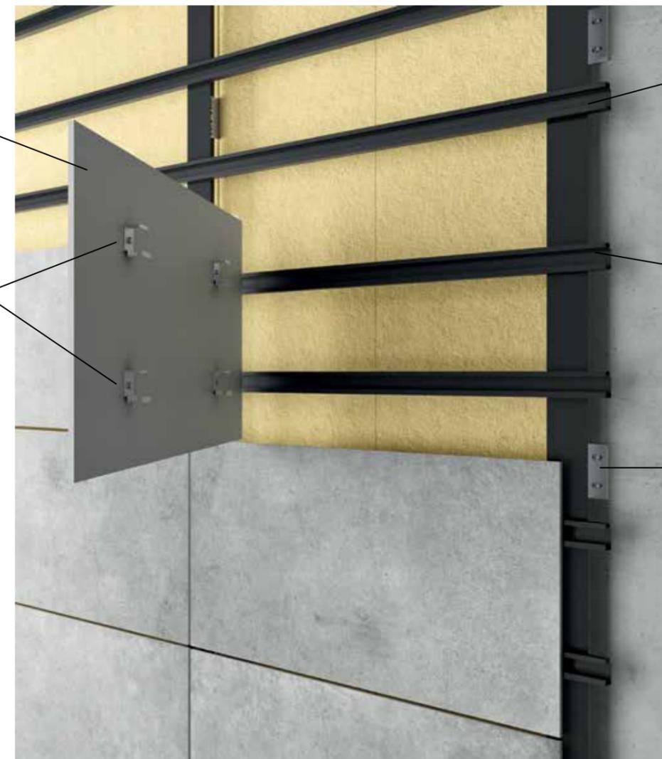
DETALLE DEL SISTEMA DE MONTAJE
