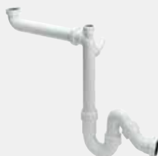
Sifón curvo economizadores de espacio - para fregadero - plástico equipamiento Codo de desagüe 45° atornillable, conexión de manguera de aguas residuales control de calidad según DIN EN 274 modelo 7850.917
