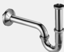
Sifón curvo sifón Plus - latón equipamiento Tubo ajustable 120 mm, codo de desagüe 220 mm control de calidad según DIN EN 274 modelo 5611.5
