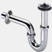
Sifón curvo - latón cromado equipamiento Válvula universal de acero inoxidable, tapón de válvula, junta plana para parte superior de la válvula, tubo ajustable 100 mm, codo de desagüe 170 mm control de calidad según DIN EN 274 modelo 5612
