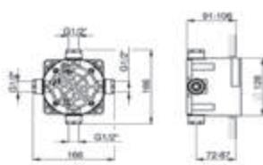
Caja universal para realizar la preinstalación de fontanería y que una vez finalizada la obra se tenga la posibilidad de elección del uso bañera/ducha con funcionalidad termostática o monomando sin tener que realizar ningún cambio en la instalación empotrada.
