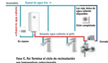
Una vez activado el sistema, el Bypass y el Módulo de Potencia se ponen en marcha para proceder a la recirculación del agua que está acumulada desde la caldera al punto de uso o grifo.
