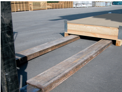
2- En el caso de coger las bandejas por el lado corto es necesario utilizar horquillas con una longitud m nima de 2,5 m.
