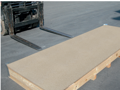
1- Para levantar y desplazar las bandejas de placas de 1000x3000 mm, utilizando carretillas elevadoras o gr as de obra, es importante coger las bandejas centradas por el lado largo.
